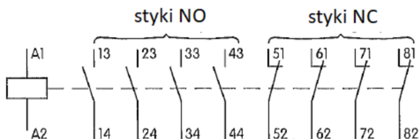
Oznaczenie dodatkowych styków pomocniczych
