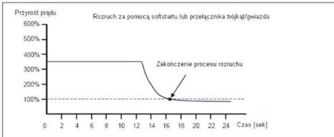
Charakterystyka prądu rozruchowego Softstart.
