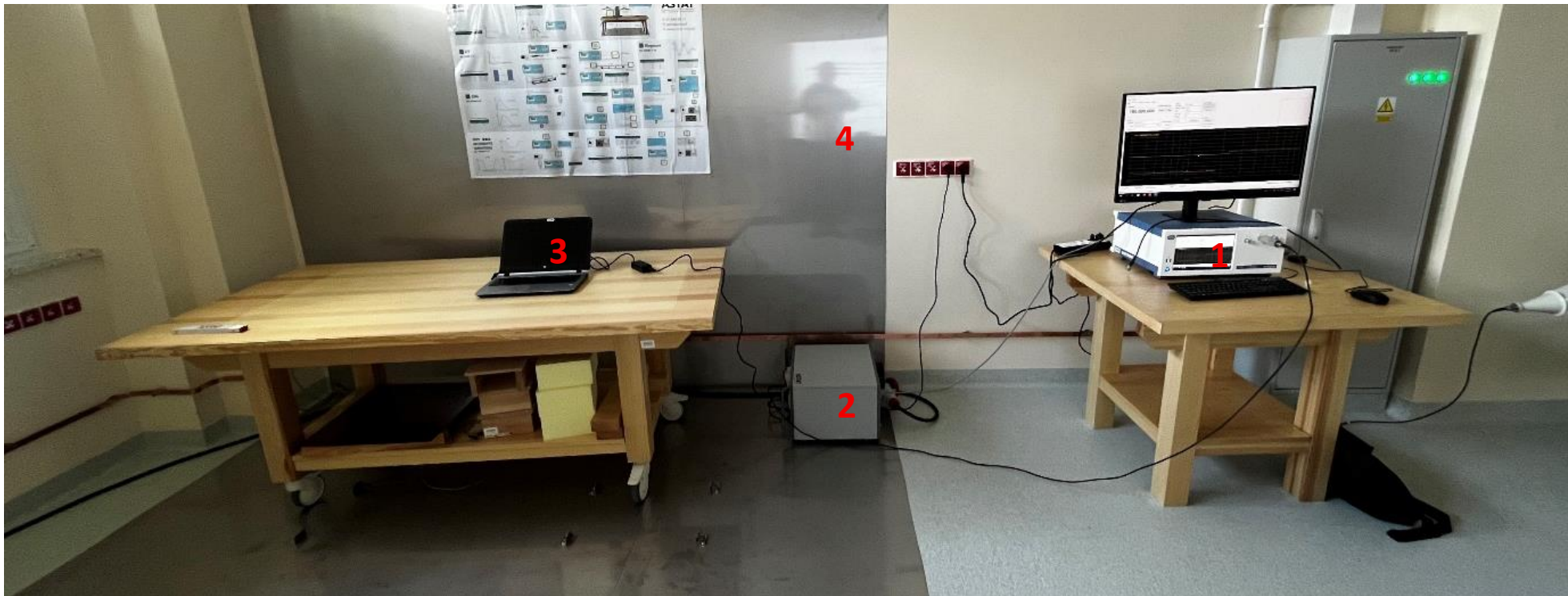
Widok stanowiska pomiarowego do emisji przewodzonej RF
