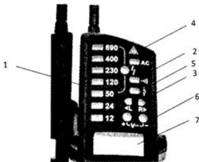
Rys. 14. Rozmieszczenie symboli związanych ze wskazaniem stanu na obudowie: 1 - wskazanie napięcia 12/24/50/120/230/400/690 V za pomocą wskaźników LED; 2 - sygnał dźwiękowy; 3 -
