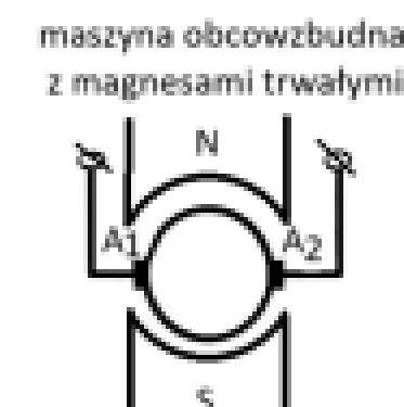
Rysunek 6 Klasyfikacja maszyn prądu stałego i stosowane oznaczenia uzwojeń
