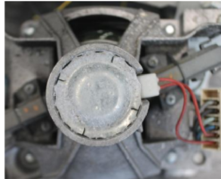
Rysunek 18 Maszyna synchroniczna z magnesami trwałymi jako prądnica tachometryczna - enkoder do sterowania prędkością obrotową silnika szeregowego.
