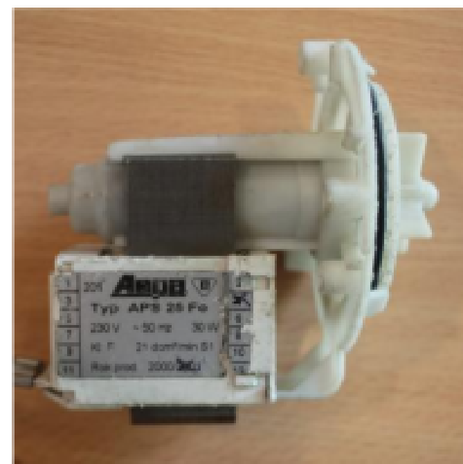
Rysunek 20 Silnik synchroniczny z magnesem trwałym w wirniku pracującym w wodzie.
