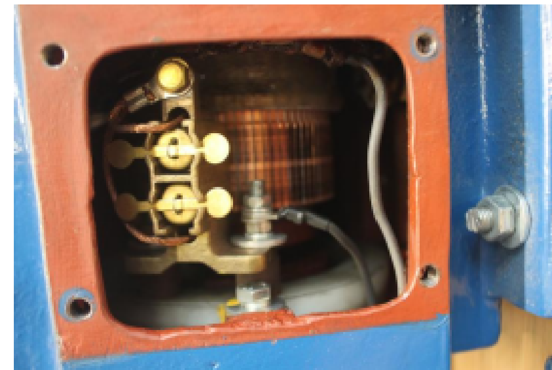
Rysunek 3 Komutator z aparatem szczotkowym
