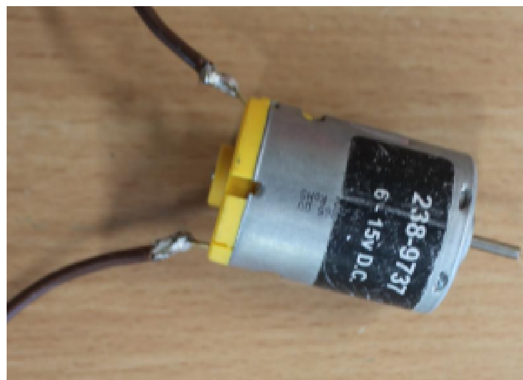
Rysunek 5 Silnik obcowzbudny z magnesami trwałymi niskonapięciowy
