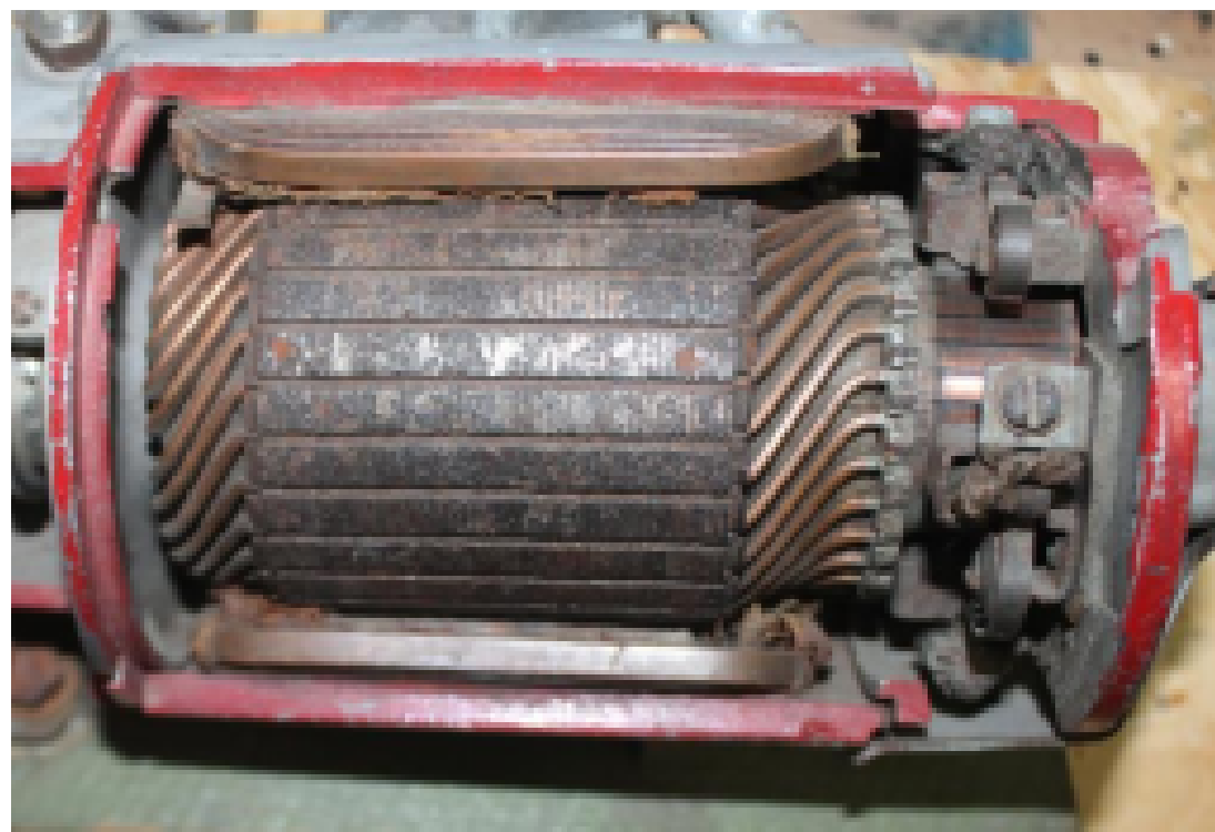
Rysunek 1 Przekrój maszyny komutatorowej szeregowej ( czterobiegunowej) ( rozrusznik samochodowy)
