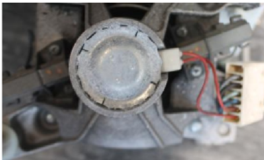
Rysunek 45 Silnik z ustawieniem ukośnym szczotkotrzymac
