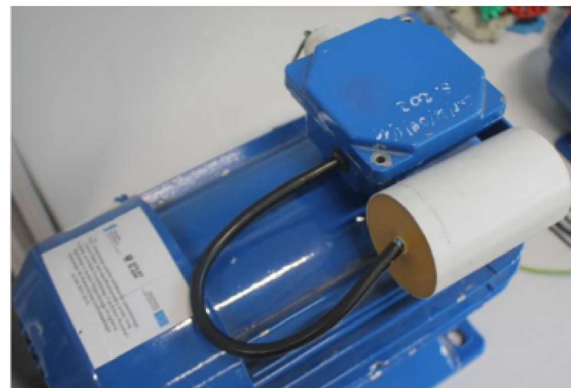
Rysunek 15 Silnik indukcyjny jednofazowy z kondensatorem
