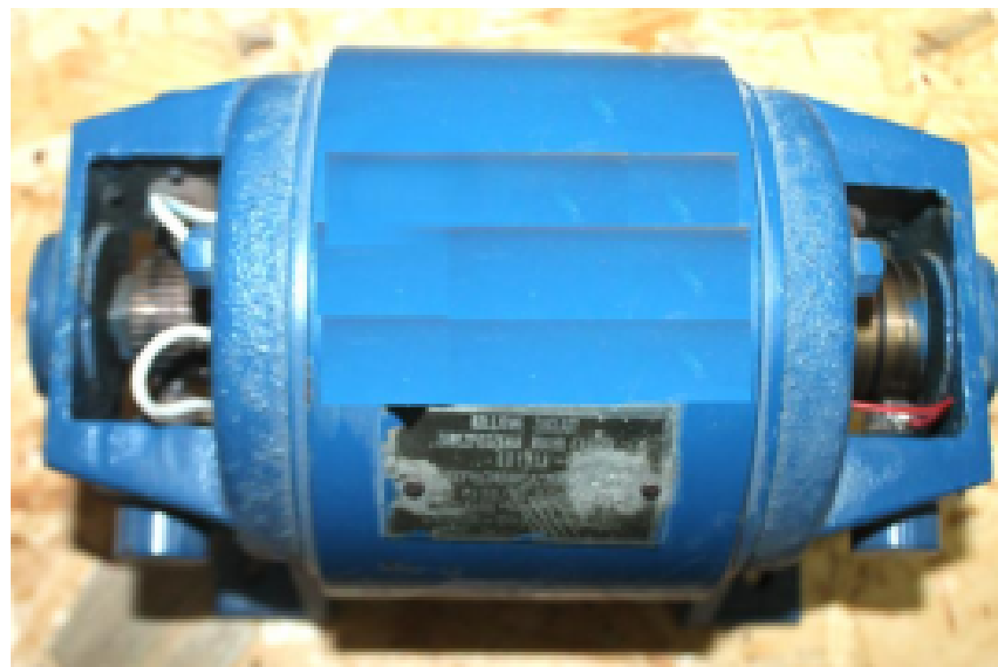
Rysunek 2. Przetownica wirująca jednotwornikowa. Lewa strona - silnik bocznikowy. Prawa strona prądnicą synchroniczną . 24V DC / 110 V 25HZ AC
