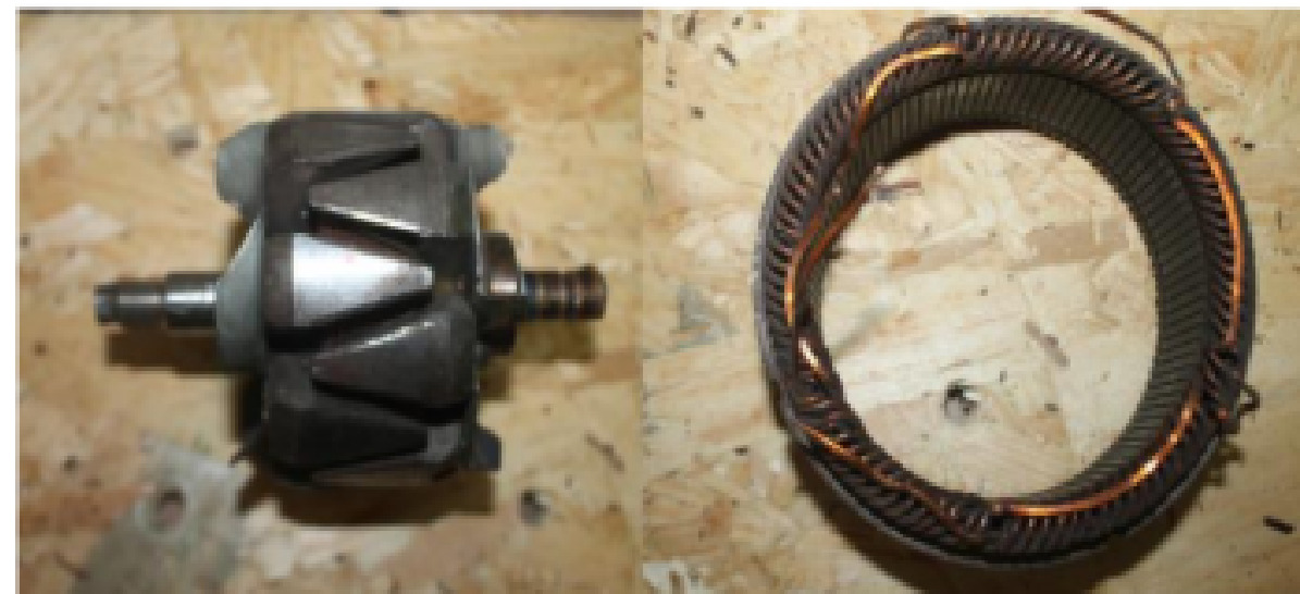
Rysunek 21 Generator synchroniczny trójfazowy. Wirnik posiada widoczne dwa pierścienie oraz tzw bieguny kłowe. ( Alternator samochodowy)
