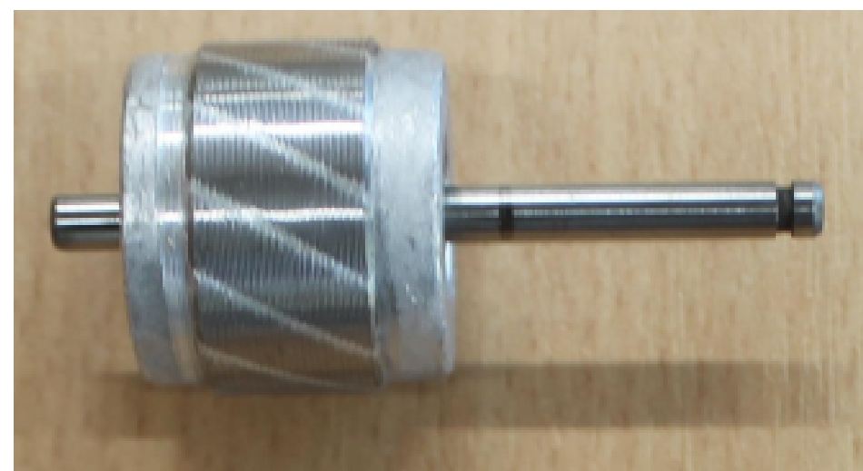
Rysunek 12 Wirnik silnika klatkowego
