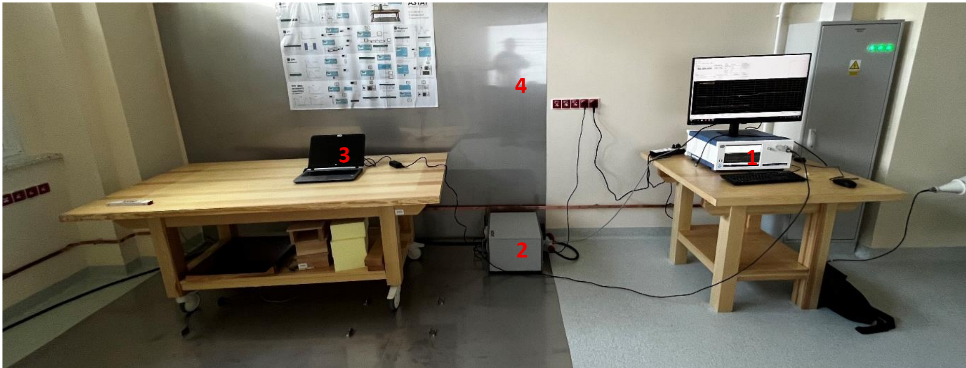
Widok stanowiska pomiarowego do emisji przewodzonej RF
