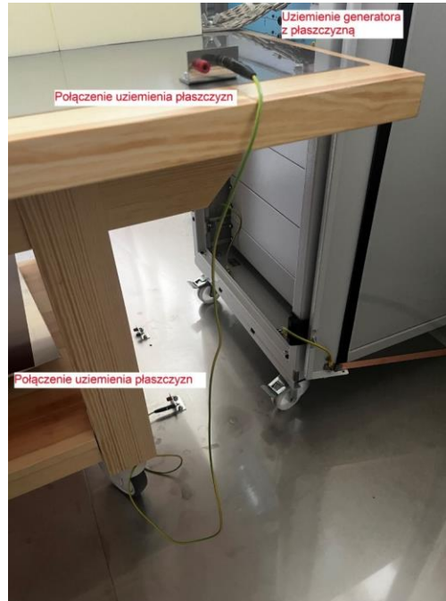
Podłączenie uziemień na stanowisku do EFT/Burst
