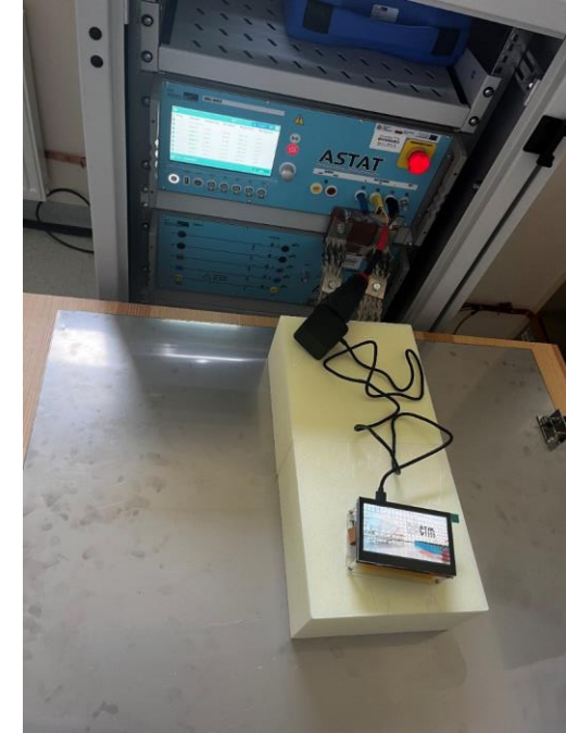
Ułożenie EUT na stanowisku do EFT/Burst.
