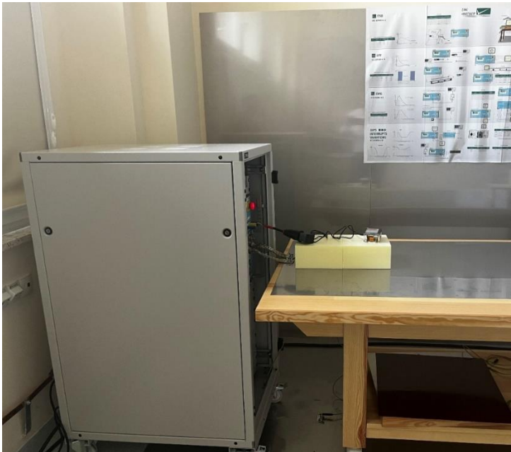
Ustawienie Szafy RACK z generatorem po lewej stronie stołu.
